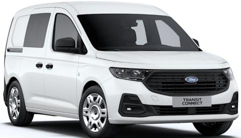
Potpuno novi TRANSIT CONNECT FLEX CAB ima novi dizajn, redizajnirani veći i duži teretni prostor u odnosu na prethodni model, povećanu snagu vuče i veću nosivost. Novi Ecoblue **dizel motor 2.0 TDCi 102KS** ima poboljšane performanse i povećanu uštedu u potrošnji goriva. U unutrašnjosti vozačke kabine postoje 2 USB priključka tip "C" snage 45 W za punjenje baterija alata, prenosnih računara ili mobilnih uređaja, a u teretnom prostoru se nalazi 12V utičnica.
