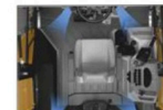
Ventilacioni otvori sa klimatizacijom
