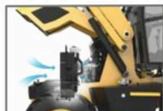
Hladnjak sa jednim slojem (lak za održavanje)
