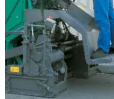
Damit die Nivelliereigenschaften der „Schwimmenden Einbaubohle“ nicht durch das Gewicht des Maschinisten beeinträchtigt werden können, ist das Trittbrett (der Laufsteg) nicht an der Einbaubohle sondern über eine Haltekonstruktion am Fertigerchassis befestigt.
